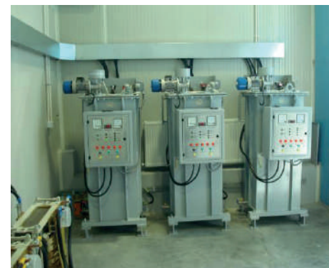
Stand de verificare la încălzire a echipamentelor electrice la curenți \leq 8000 A, tip SVI-01
