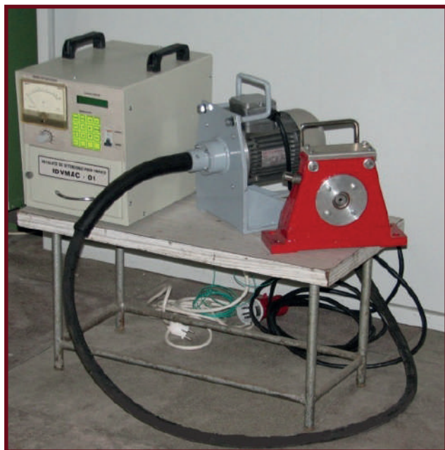
Instalație de detensionare prin vibrații mecanice controlate, cu motor asincron și microcontroller
