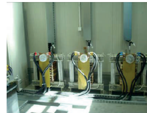
Stand de verificare la încălzire a echipamentelor electrice la curenți \leq 8000 A, tip SVI-01
